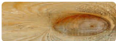
**LE CONTRE FIL:** Le contre-fil apparaît lors du rabotage de la lame de bois; au cours du profilage, il arrive que des fibres «désorientées» soient arrachées par les couteaux. (Ce phénomène ne peut pas remettre en cause la qualité du rabotage).
