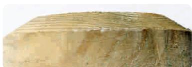
**LA MOELLE:** La moelle constitue la partie centrale du tronc. Elle est formée d'un tissu plus tendre et léger que celui du reste du tronc. Ainsi, quand une lame de bois est traversée de moelle, il arrive que le profilage la rende visible sur une partie ou toute sa longueur. Ce désordre est principalement visuel et ne remet pas en cause la bonne tenue du parement.
