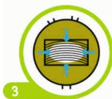
**Etape 3 :** Une pression hydraulique est appliquée, forçant l'imprégnation profonde du produit de préservation dans les cellules du bois.
