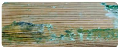
**GRISAILLEMENT:** Le grisaillement est un phénomène naturel. Il découle du "délavement" du produit sous l'action des rayons UV du soleil. On peut l'éviter en recouvrant le produit, avant la pose, d'une lasure, d'une peinture à bois, d'un vernis. Le but : obtenir une filtration des UV.
